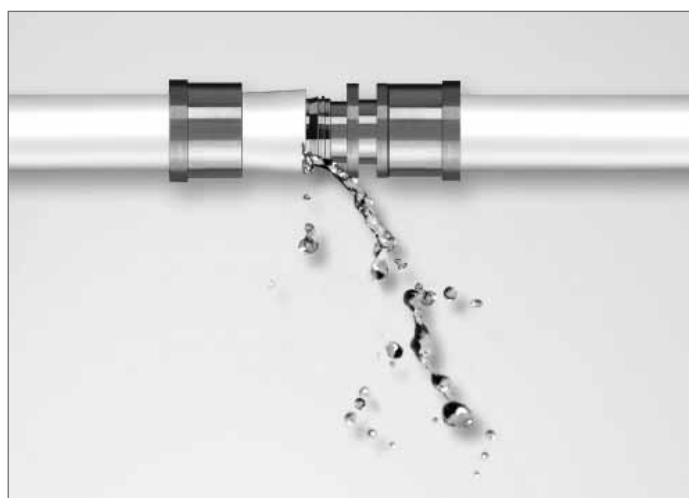
Kontrola wzrokowa niezaciśniętego połączenia aksjalnego
