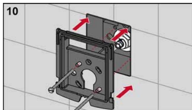
10 Avvitare il telaio all'alloggiamento della valvola.
