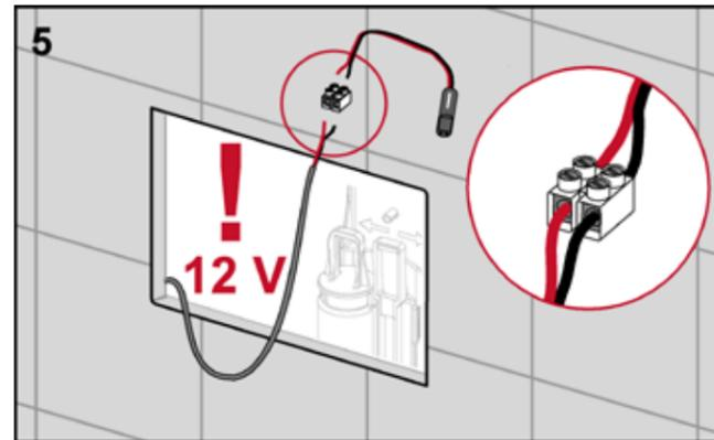
Collegare il cavo del trasformatore all'adattatore di rete (attenzione alla polarità - vedi dettaglio in fig. 5).
