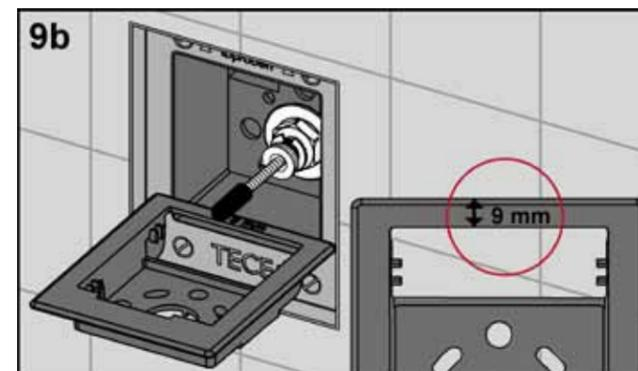
Avvitare l'asta di comando come descritto sopra (es. per TECEloop a filo parete, distanza dalla parete = 9 mm) e fissarla con il controdado per non farla girare. Nella parte superiore del telaio della placca è riportata la lunghezza di regolazione dell'asta di comando per facilitare la regolazione.
