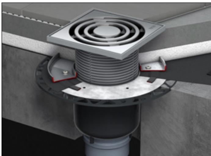
Установка в подвале, гидроизоляция зажимным фланцем.
