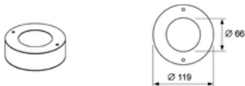
Устройство состоит из противопожарного отсекавателя, двух винтов с крестообразным шлицем, шильдика и 150-миллиметрового отрезка трубы PP-НТ соответствующей DIN EN 1451.
