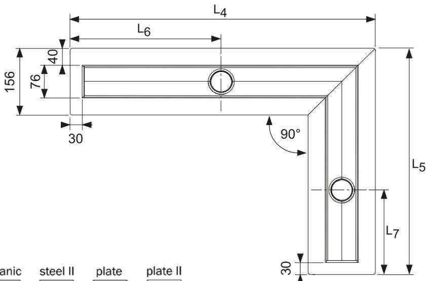
\* max. distanza tra il bordo esterno della canalina ed il centro scarico = 750 mm
