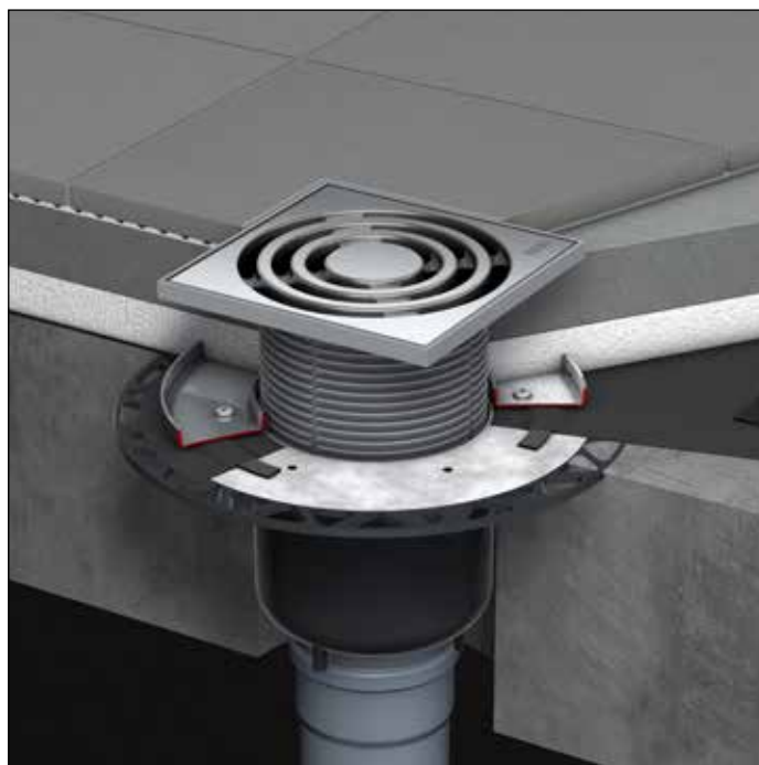
Einbau im Kellerbereich, Abdichtung mit Klemmflanschabdichtung
