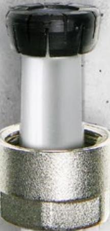
Die Normung für Kunststoffrohre lässt eine breite Maßtoleranz zu. Eine „Dimension 16 x 2“ kann im Innendurchmesser bei verschiedenen Herstellern einige Zehntelmillimeter abweichen! Treffen ungünstige Herstellerpaarungen von Klemmverschraubung und Rohr aufeinander, kann es zu Leckagen kommen. Im TECEfloor System sind Rohr und Fitting perfekt aufeinander abgestimmt.
