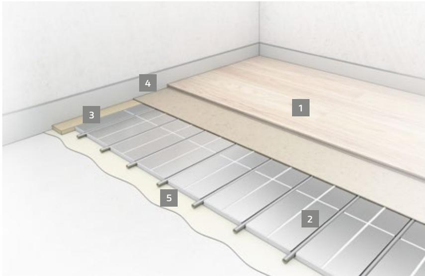
TECEfloor Universalpanel 16/12 mit schwimmend verlegtem Fertigparkett. Gesamtaufbau inklusive Bodenbelag: 33 mm.
