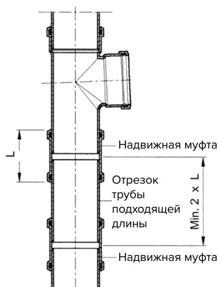
Монтаж тройника с двумя надвижными муфтами
