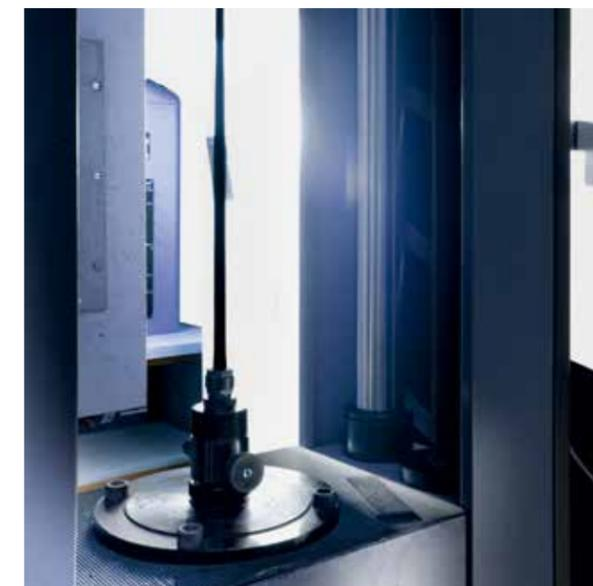
Anlage zur Durchführung von Zugversuchen an Installationsrohren
