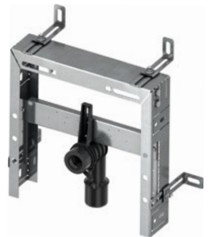
TECEbox-wastafelframe, inbouwdiepte 8 cm: Te monteren voor een massieve wand. Met vier in diepte verstelbare wandbevestigingen. Inbouwdiepte 8-19 cm. Keramische bevestigingsafstand 17-28 cm.
