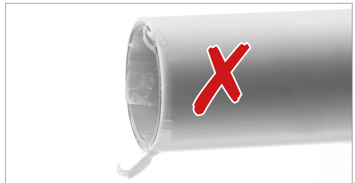
Feil kalibrert rør
