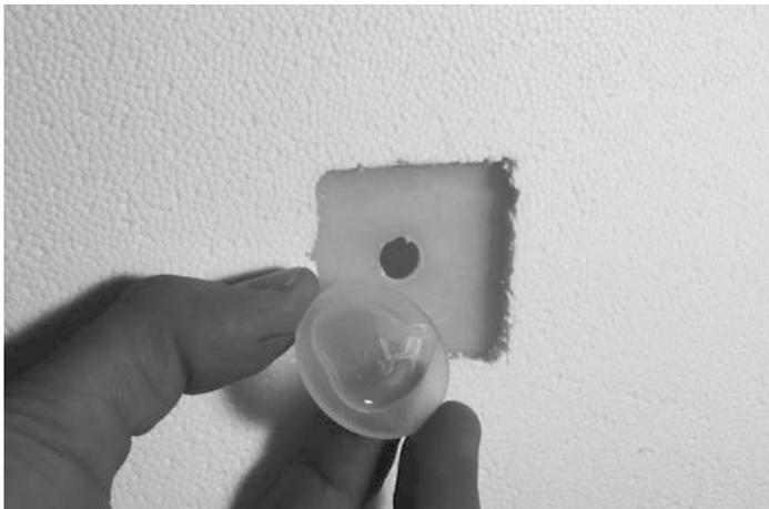
Сразу же наложите диск на отверстие и плотно прижмите. Время высыхания — приблизительно 15 минут. Заполните бачок и проверьте его герметичность.
