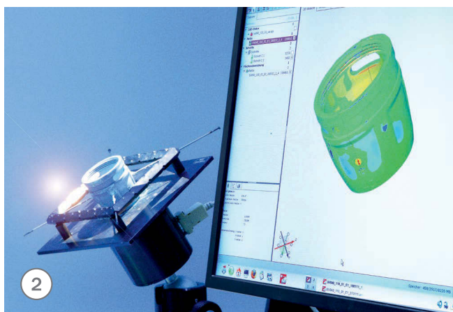
(1) Установка для проверки прочности соединения труб, (2) 3D сканер для проверки фитингов TECElogo, (3) Испытание трубы TECElogo на растяжение.
