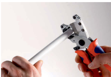
Обрезаем трубу при помощи труборезных ножниц...
