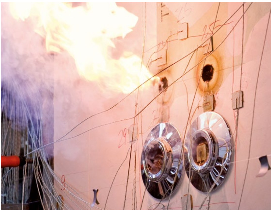
Brandtest bij het testinstituut Materialprüfanstalt für das Bauwesen in Braunschweig. Afhankelijk van de uitvoering van de sanitairwand werden er bij eenzijdige brandbelasting brandweerstandsklassen tot F 120 bereikt.
