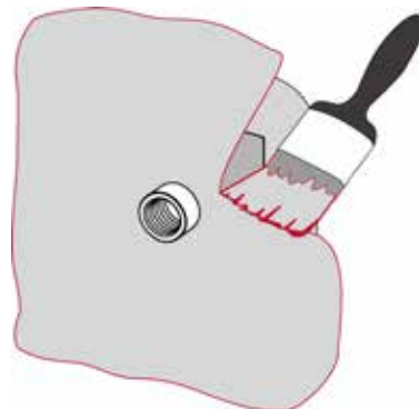
Bild 3: Aufbringen des oberen Dichtanstrichs
