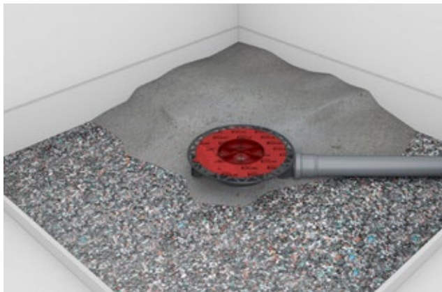
Stap 2: De dekvloer wordt nu afgemaakt.
