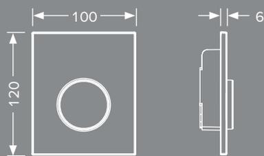
Plaques de déclenchement TECEloop en plastique, cartouche de robinetterie de chasse pour boîtier de chasse U1 comprise. Dimensions : 100 x 120 x 6 mm
