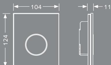
Plaques de déclenchement TECEloop en verre, cartouche de robinetterie de chasse pour boîtier de chasse U1 comprise. Dimensions : 104 x 124 x 11 mm
