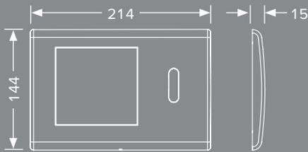
En complément de la mesure de la distance d'une personne, le capteur reconnaît l'angle d'incidence de la lumière qu'elle reflète. Le déclenchement de la chasse ne dépend donc pas de la couleur des vêtements que la personne porte. Le champ de détection peut être déterminé avec exactitude et séparé de l'arrière-plan. La programmation de l'électronique est facile et s'effectue selon la demande.
