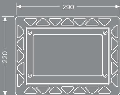
Avec le kit d'encastrement spécial, il est possible de réaliser des montages à fleur de paroi uniques des variantes en verre.
