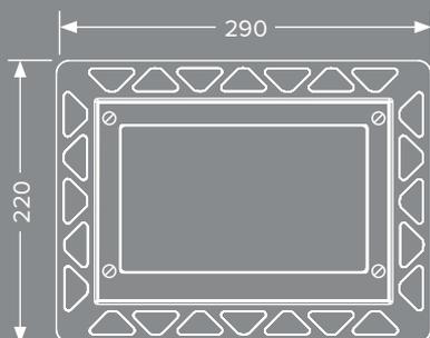
Les plaques de déclenchement TECESquare avec la surface en verre peuvent être montées complètement à fleur de paroi à l'aide d'un kit d'encastrement.
