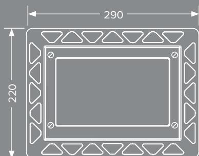
Pour le montage à fleur de paroi de TECEnow, la combinaison d'un kit d'encastrement et d'un cadre de finition est nécessaire, les deux peuvent être commandés séparément.
