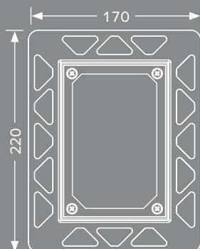
Pour les versions en verre et en plastique, la TECEfilo peut être montée à fleur de paroi. Un cadre de finition spécial est également nécessaire. Il peut être commandé séparément.
