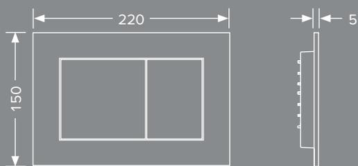
TECEnow est une plaque de déclenchement en plastique pour WC, pour les réservoirs TECE avec déclenchement frontal ou par le dessus.
