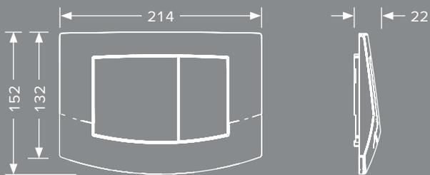
Les plaques de déclenchement en plastique pour WC peuvent être activées par l'avant ou par le dessus. Grâce à une butée amortie des deux côtés par du caoutchouc, les bruits de claquement lors du déclenchement sont réduits de manière fiable.
