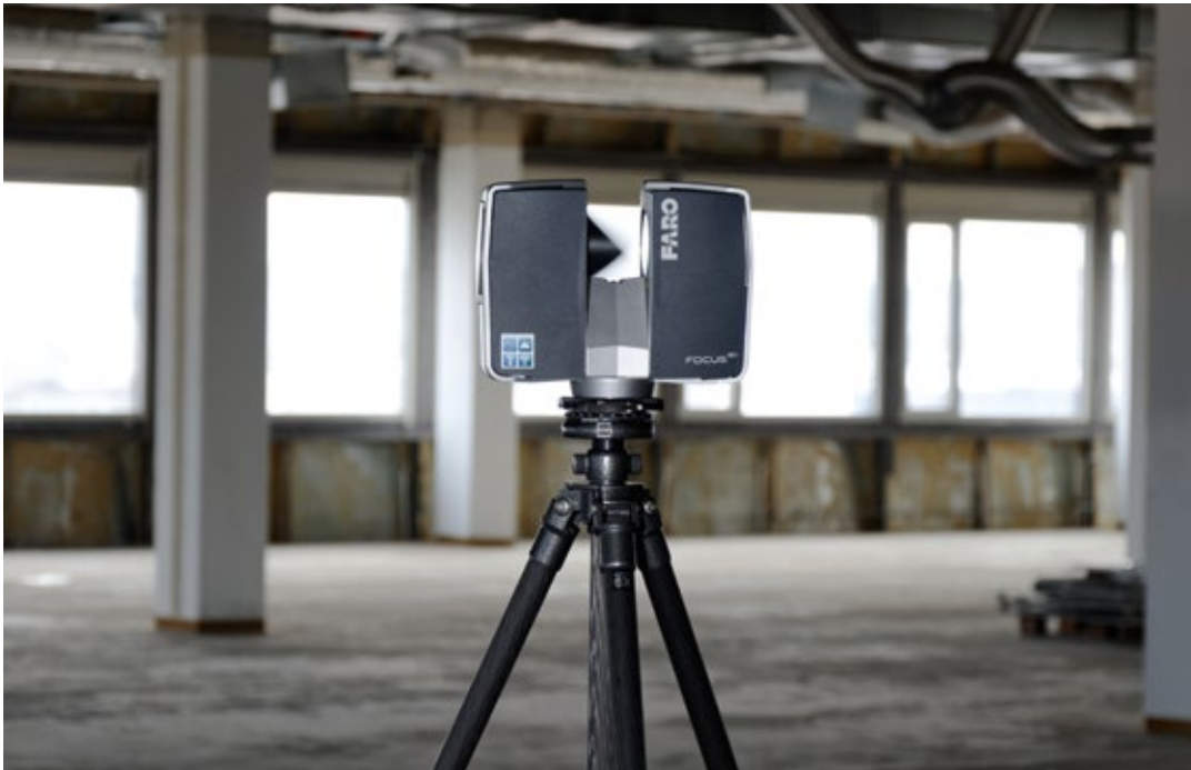
Laserscanner verwandeln eine Bestandsbausituation in eine Punktwolke, die als Aufmaß in ein CAD-Programm geladen werden kann. Aufmaß-Dienstleister nehmen dem Bäderbauer diese Arbeit ab. Bild: www.faro.com
