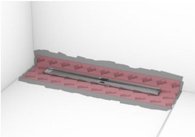
**Étape6** : On installe la manchette d'étanchéité dans le système d'étanchéité liquide.
