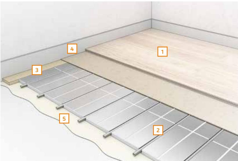
TECEfloor Universalpanel 16/12 mit schwimmend verlegtem Fertigparkett. Gesamtaufbau inklusive Bodenbelag: 33 mm.
