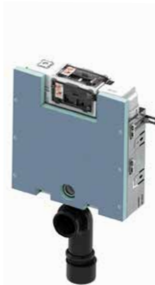
TECEbox WC-Modul mit Uni-Spülkasten und Fliesenträger-Front, Bauhöhe 820 mm: WC-Modul für den Einbau in eine gemauerte Vorwand vor einer Massivwand, in der Tiefe verstellbar.
