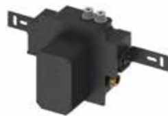
TECEbox Urinalspülgehäuse U 2: Zur Montage des TECE Urinalspülers U 2 im Nassbau. Zur Kombination mit TECEfilo Urinalelektroniken.
