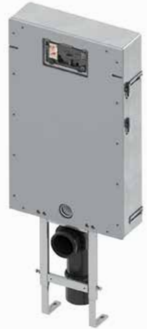
TECEbox WC-Modul mit Uni-Spülkasten, mit verfliesungsfähiger Frontverkleidung, Bauhöhe 1110 mm: WC-Modul für den Einbau in eine gemauerte Vorwand. Geschlossene, verfliesungsfähige Oberfläche aus Glasfaser-Leichtbeton. Inklusive vormontierter, höhenverstellbarer Stützfüße.
