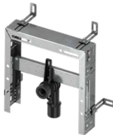
TECEbox Waschtischmodul, Bautiefe 8 cm: Zum Einmauern vor einer Massivwand. Mit vier tiefenverstellbaren Wandbefestigungen. Einbautiefe 8 bis 19 cm. Keramikbefestigungsabstand 17 bis 28 cm.
