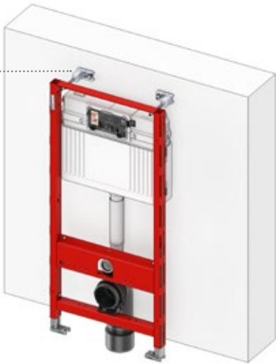
Variabel tiefen- und höhenverstellbare TECEprofil Modulbefestigung für 1190 bis 1300 mm Höhe.
