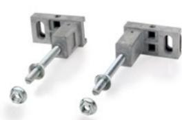
**Fixation de cloison** pour le montage d'un réservoir encastré ou d'un cadre de montage à un mur plein, réglable en profondeur de 150 à 240 mm.
