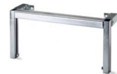
**Cadre télescopique** pour le montage d'un réservoir encastré ou d'un cadre de montage à un mur plein. Il est ici possible de régler la hauteur et la profondeur de la surface de fixation. Hauteur réglable de 1 190 à 1 300 mm.
