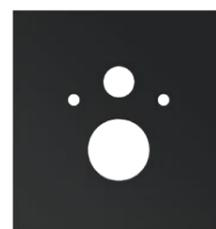
Raccordements normalisés pour cuvette suspendue au mur
