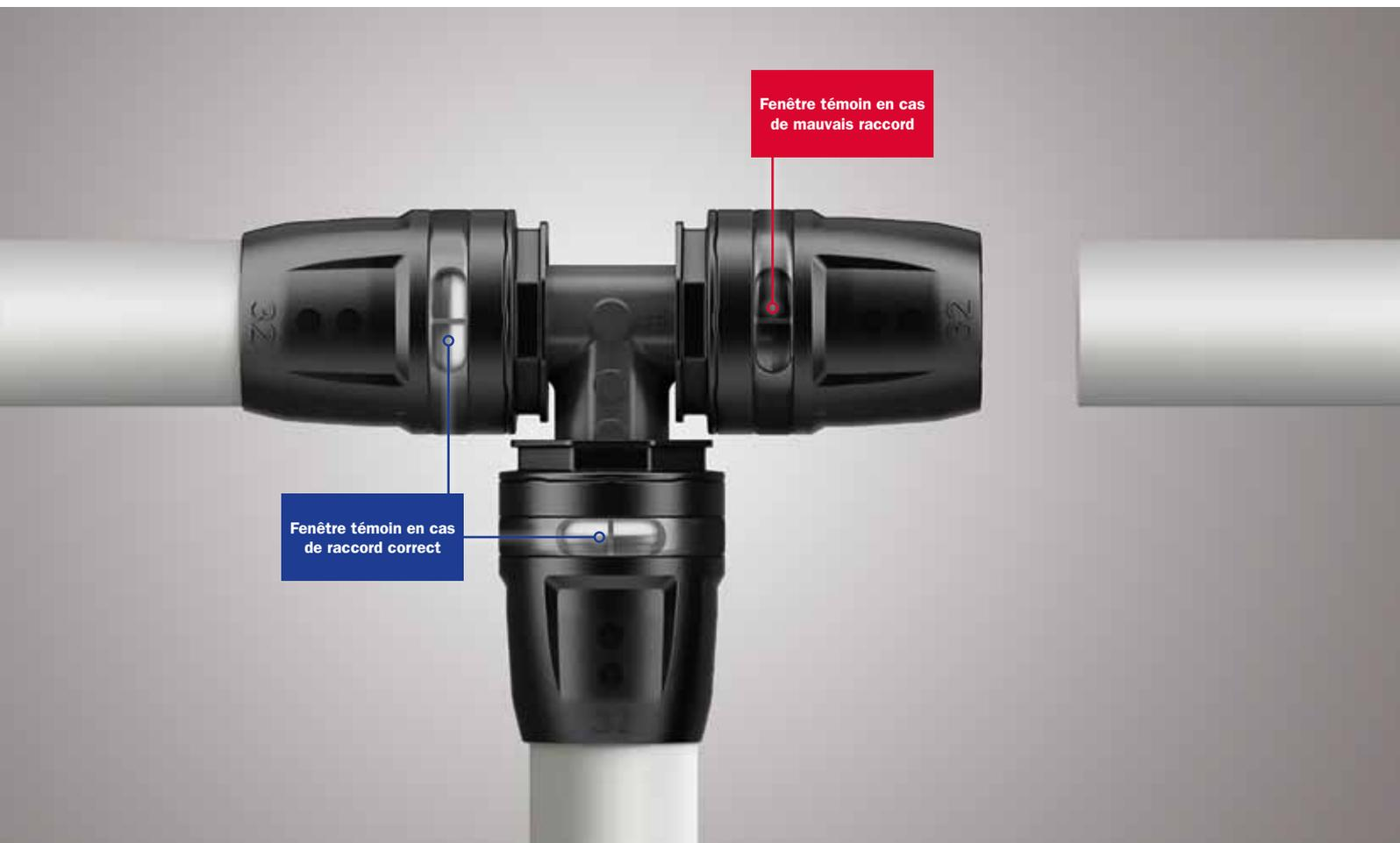
La fenêtre témoin étanche permet de contrôler visuellement l'emboîtement.
