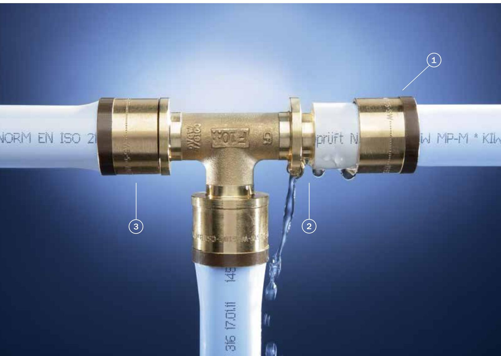
**TECEflex élimine tout risque d'erreur : oublié de presser ? Impossible ! Les raccords non pressés sautent deux fois plus clairement aux yeux avec TECEflex. Le manchon de pression n'est pas fixé et une fuite de liquide a lieu dès le test de pression.**
