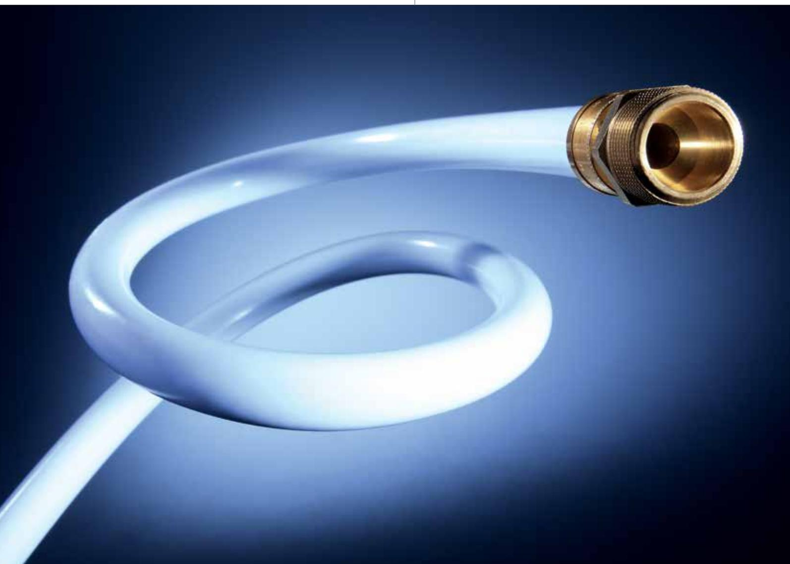
Le tube TECEflex est très flexible et peut être cintré à la main jusqu'à la taille 32 lorsque la place manque. Cela facilite le déplacement, avec le moins possible de raccordements. Aucun outil de cintrage n'est requis car le tube est indéformable et ne se plie pas.
