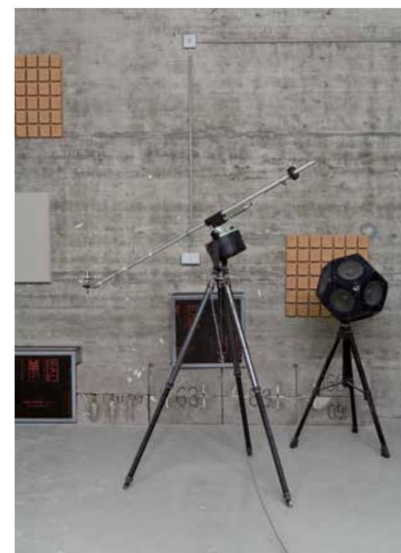
Des essais d'insonorisation sur un module sanitaire de salle de bains TECE à l'Institut de physique de construction de Fraunhofer. Mieux vaut avoir un faible niveau sonore dans les hôtels, mais cela vaut aussi pour les résidences privées. Des éléments d'absorption des sons spéciaux sont employés dans le système TECEprofil pour assurer des niveaux sonores bas. Des rapports indépendants confirment la transmission réduite des ondes sonores dans la structure du bâtiment.
