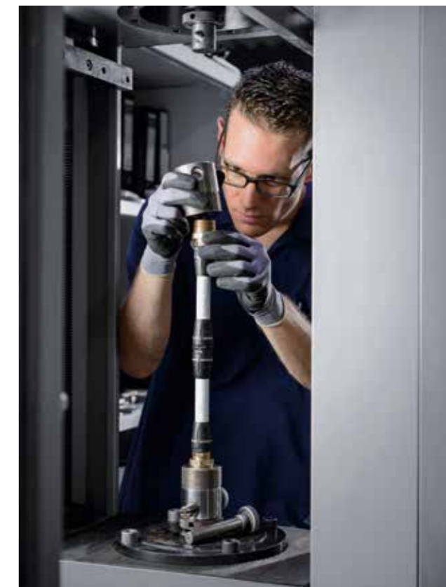
Les tubes et les raccords sont soumis à des essais de résistance à l'arrachement pour garantir une sécurité optimale. Cela garantit que l'installation restera fiable à long terme.
