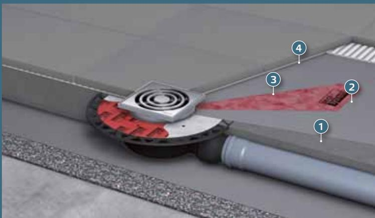
▲ Raccord d'étanchéité Seal System certifié avec un point d'évacuation sur la chape (1). La manchette (3) est ici placée et noyée dans la première couche encore humide d'enduit d'étanchéité (2), avant d'être recouverte d'une deuxième couche (4).
