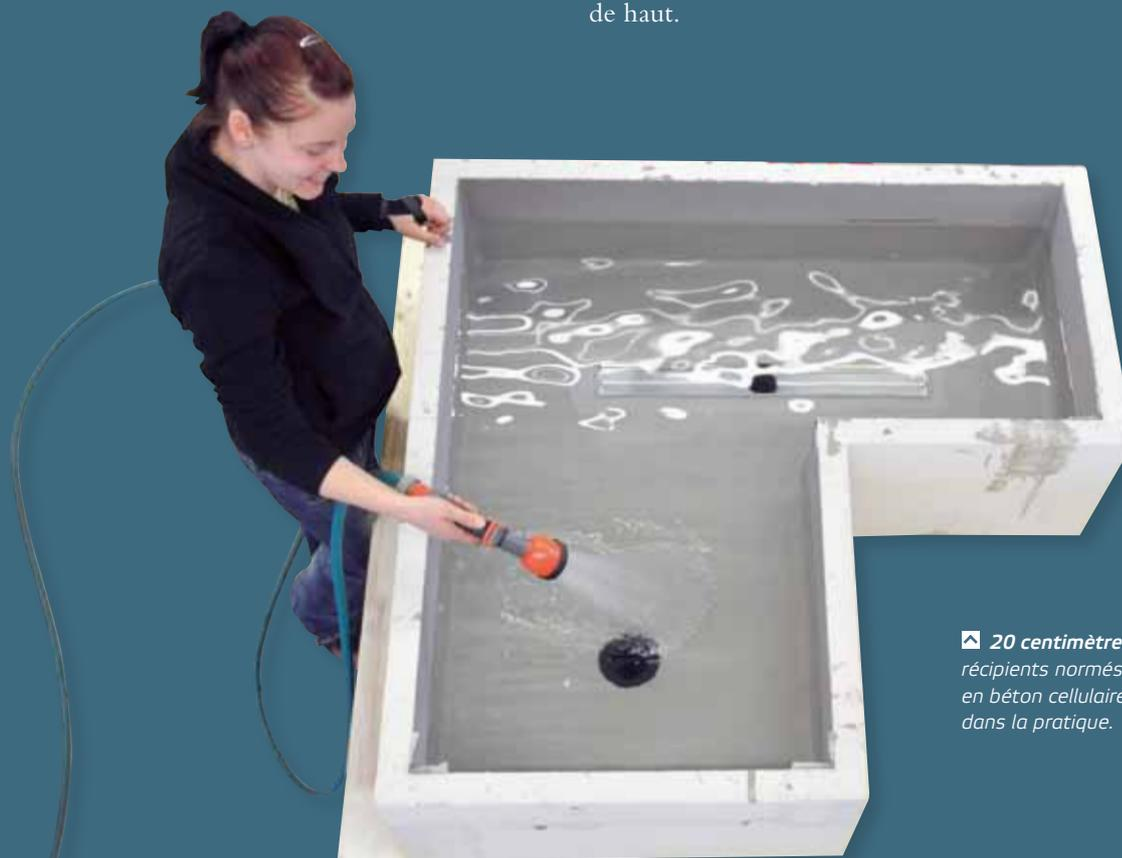
☒ 20 centimètres d'eau : des récipients normés hexagonaux, en béton cellulaire sont testés dans la pratique.
