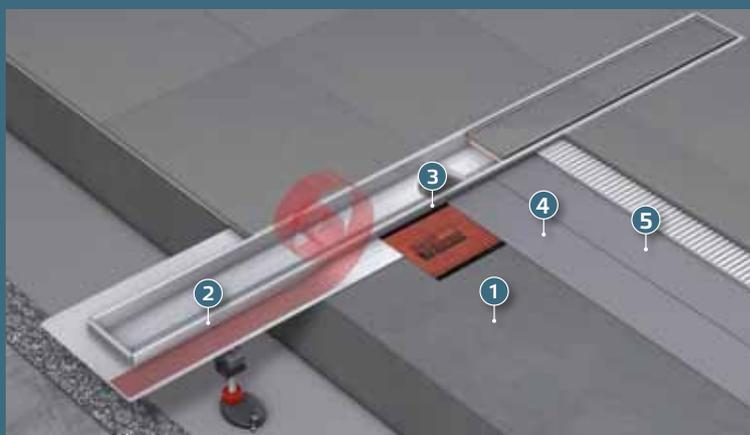
▲ Giunto di tenuta certificato Seal System in una doccia a filo pavimento con impermeabilizzante sottile a due strati (4 + 5) e fascia sigillante Seal System (3) tra flangia in acciaio inox (2) e massetto (1).
