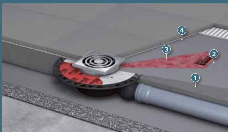
▲ Giunto di tenuta certificato Seal System con drenaggio puntuale su massetto (1). Il manicotto di tenuta (3) viene in questo caso inserito prima della posa del primo strato di sigillante (2), in seguito viene inglobato nel sigillante e ricoperto poi con il secondo strato (4).
