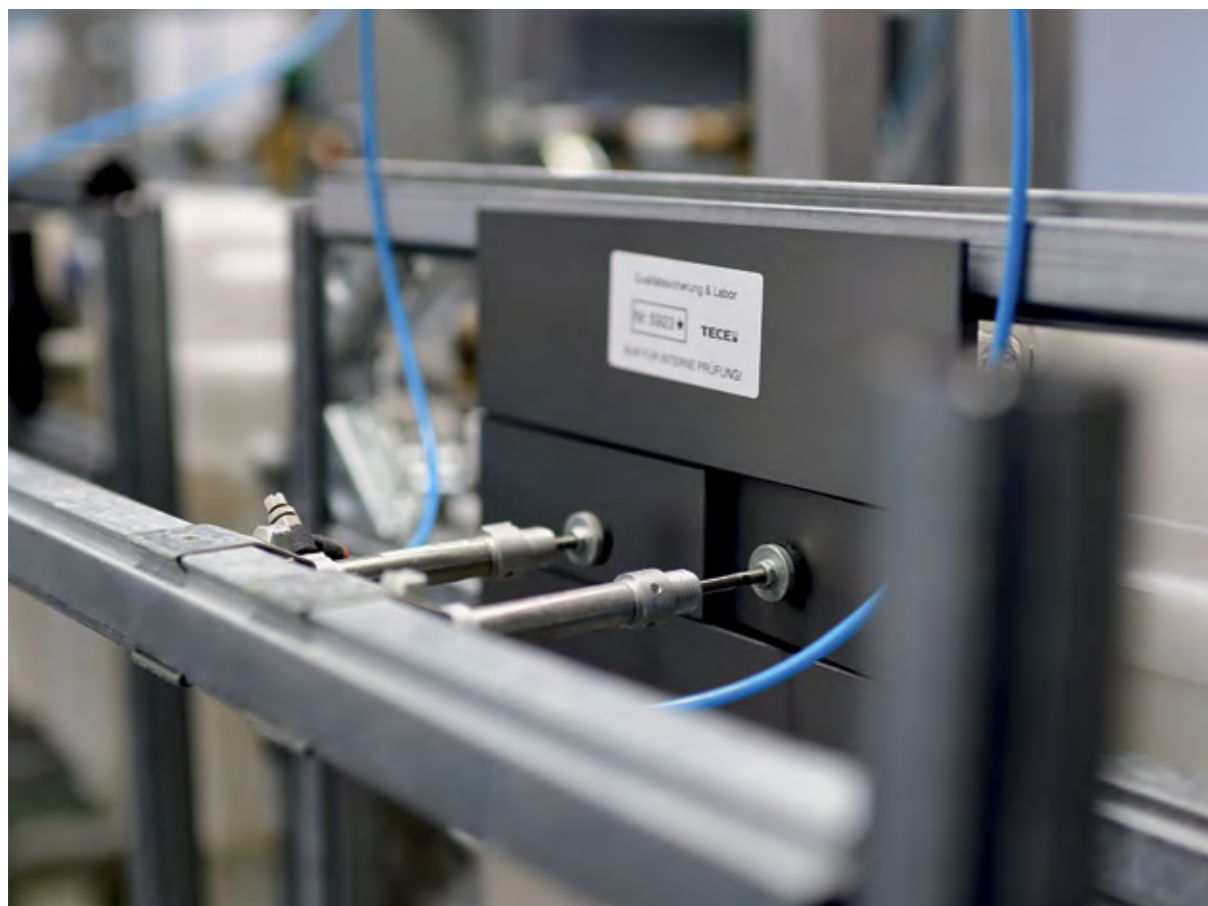
Il meccanismo di azionamento delle placche viene sottoposto a uno stress-test di 200.000 cicli. Dopo il test deve preservare una completa funzionalità.
