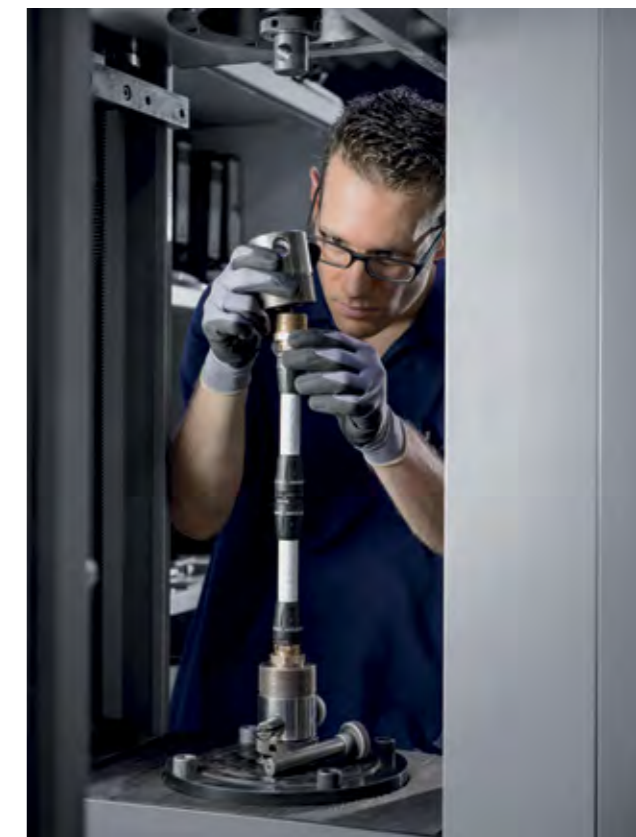
Tubi e collegamenti vengono sottoposti a prove di resistenza per garantire una sicurezza ai massimi livelli. Questo garantisce all'installazione di rimanere stabile nel lungo termine.
