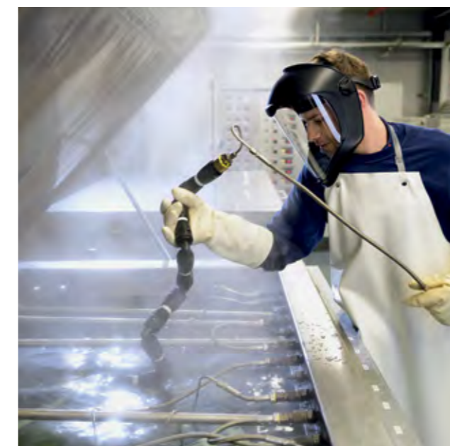
Un "albero di prova" dotato di vari punti di connessione, viene testato immergendolo in acqua a 90°C e 10 bar per controllarne la tenuta. Eventuali perdite su componenti difettosi possono essere identificate rapidamente. Tutte le parti prodotte vengono smontate per ulteriori controlli tramite il sistema di tracciamento dei lotti.
