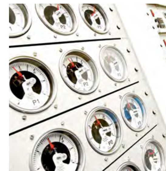
Nel laboratorio di prova dei tubi di distribuzione, vengono indicati e monitorati i punti standard sulla curva del tempo di rottura. Ad esempio, viene misurata e registrata la durata di un campione di tubo a 90°C e 10 bar.
