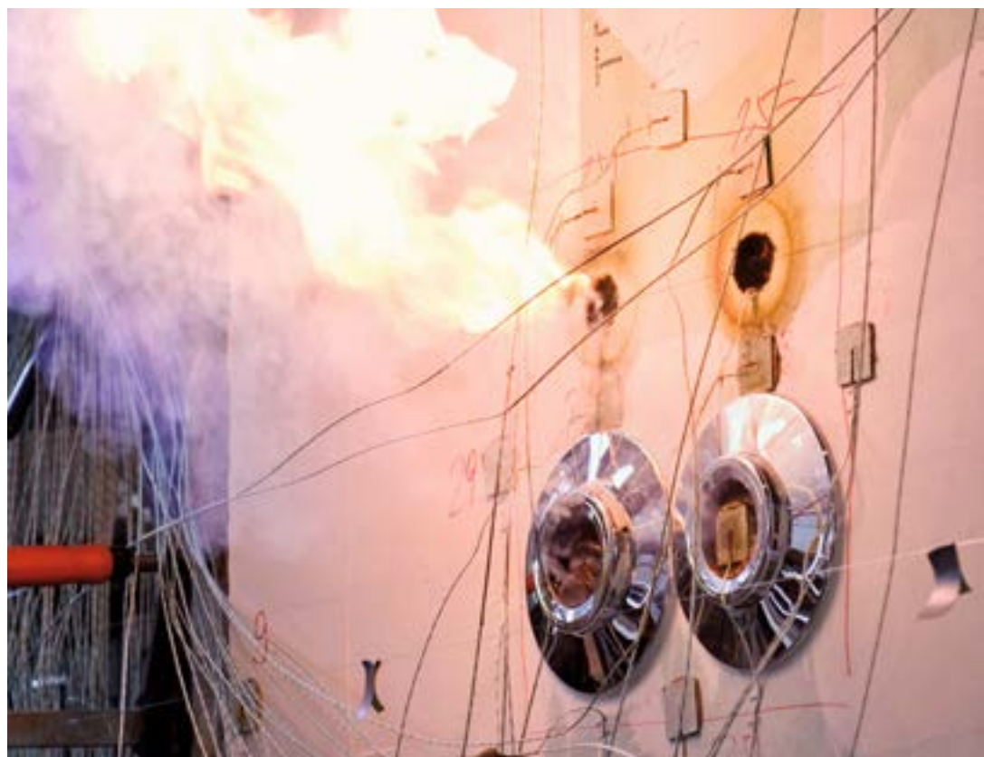
Badania ochrony przeciwpożarowej przeprowadza się w Instytucie Testowania Materiałów w Brunzwicku w Niemczech. W zależności od rodzaju systemowej ścianki łazienkowej, podczas jednostronnego poddania ścianki próbie ogniowej, osiągnięto klasę odporności do F 120.
