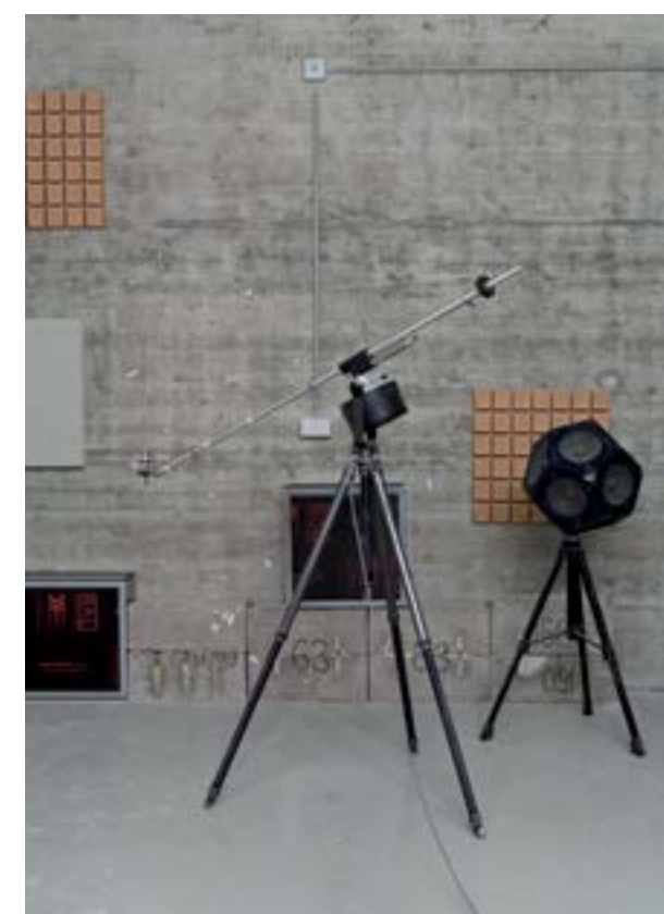
Badania dźwiękoszczelności ścianki działowej TECE do łazienki w Instytucie Fizyki Budowlanej Fraunhofer. W hotelach rozsądne jest utrzymywanie hałasu na niskim poziomie, ale to samo dotyczy także mieszkań prywatnych. W systemie TECEprofil zapewniają to specjalne elementy dźwiękochłonne. Niezależne raporty na jego temat potwierdzają zmniejszoną transmisję fal dźwiękowych w konstrukcji budowlanej.
