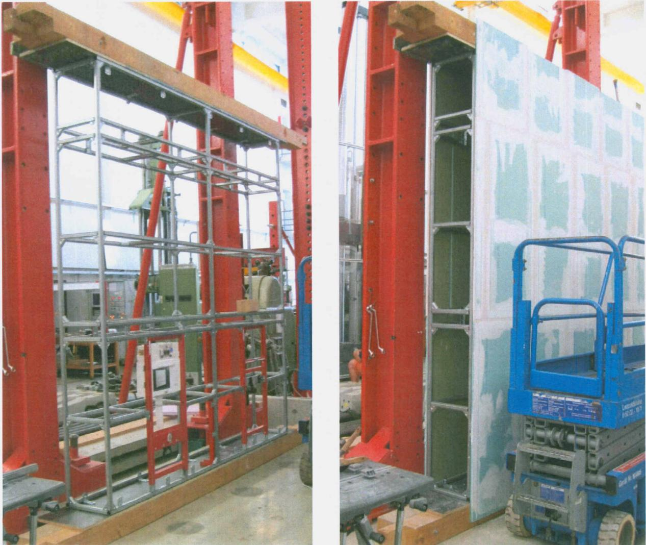
Bild 1: Leichte Trennwand, Bauart TECE. Auf dem linken Bild ist das fertige Raumfachwerk im Versuchsrahmen der MPA Braunschweig aufgebaut. Auf dem rechten Bild ist die leichte Trennwand bereits beplankt und die Fugen sind verspachtelt.
