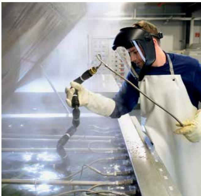
При «иерархическом испытании» проверяется наличие утечек в различных точках соединения в водяной ванне при температуре 90°C и давлении 10 бар. Таким способом можно быстро определить утечки на неисправных компонентах. Все изготавливаемые детали поступают для последующих проверок в системе отслеживания партий.
