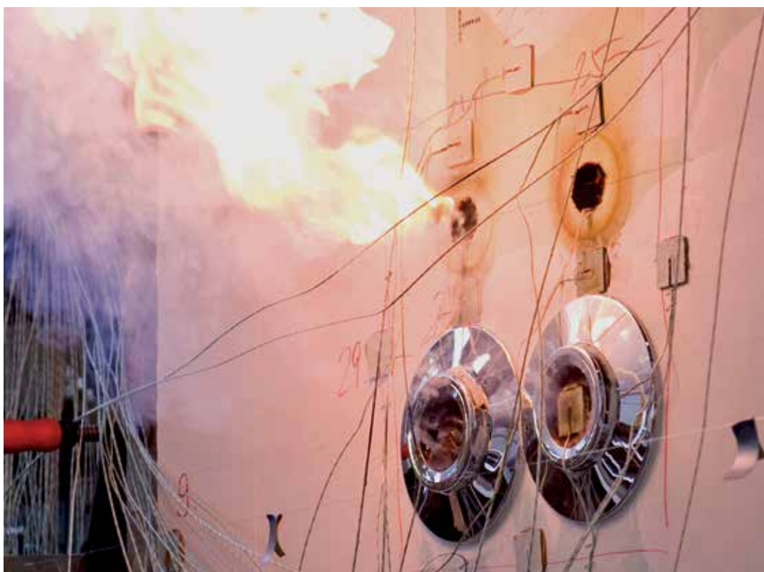
Испытание огнестойкости в Брауншвайгском институте испытаний материалов для гражданского строительства (Германия). В зависимости от дизайна стеновой секции ванной комнаты при воздействии огня с одной стороны были достигнуты классы огнестойкости до F 120.
