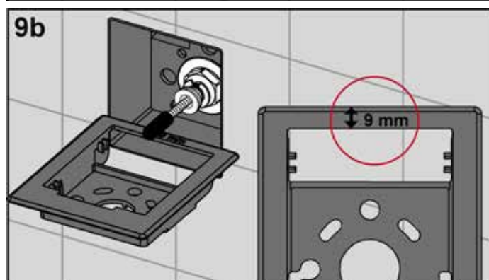
Drehen Sie die Betätigungsstange so weit wie vorgeschrieben ein (bei TECEloop 9 mm Abstand zur Wandoberfläche) und sichern Sie sie mit der Kontermutter gegen das Verdrehen. An der Oberseite des Befestigungsrahmens ist die Einstelllänge für die Betätigungsstange gekennzeichnet. Damit können Sie die Einstellung schnell und einfach vornehmen.
