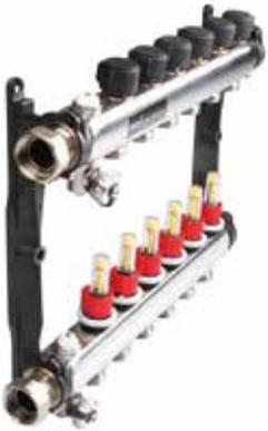
Er besitzt integrierte Rücklaufventile mit doppelter O-Ring Dichtung am Ventilstößel, Ventilteller mit O-Ring Dichtung zum dauerhaft sicheren Schließen der Heizkreise und eine absperrbare Durchflussmesser 0,5–4 Liter mit Arretierung gem. DIN EN 1264-4.
