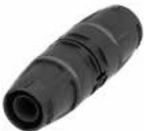
Zum einfachen, schnellen und drallfreien Verbinden der TECEfloor Systemrohre Art.-Nr. 771416xx und 771516xx. Steckfitting auf Basis der innovativen TECElogo Technologie.
