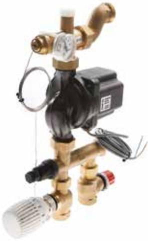
Die TECEfloor Festwertregelung als Verteilerstation regelt über einen Thermostatkopf mit Vorlauffühler die Wassertemperatur im sekundären Fußbodenheizbereich. Diese liegt solange unter der primärseitigen Wassertemperatur wie diese – in der Regel witterungsgeführte Wassertemperatur – oberhalb des an der Festwertregelung eingestellten Wertes ist. Sinkt die primärseitige Wassertemperatur auf Grund der Heizkurvein-
