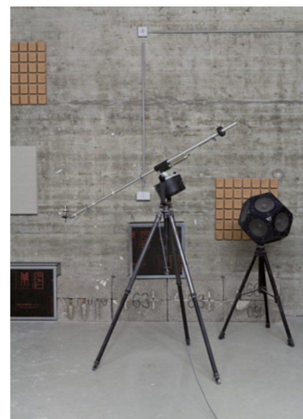
Ljudisoleringstest på en TECE badrumsväggsektion vid Fraunhofer Institut för byggnadsfysik. Det är bra att ha låg ljudnivå på hotell, men det samma gäller också privatbostäder. Speciella ljudisolerande element används i TECEprofil-system för att säkerställa låga ljudnivåer. Oberoende rapporter bekräftar den minskade överföringen av ljudvågor till byggnadens stomme.
