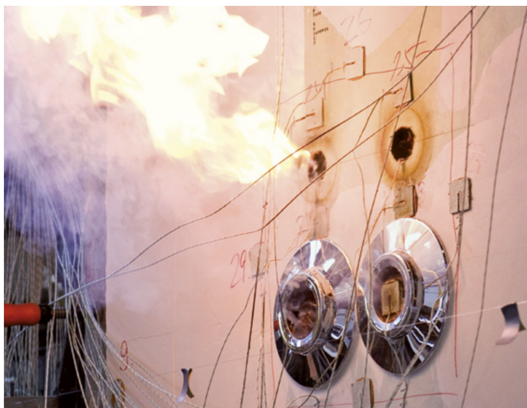
Brannbestandighetstester ved Material Testing Institute i Braunschweig (Tyskland). Avhengig av designet på baderoms vegg-seksjonen, når den ble utsatt for brann på en side, ble brannbestandighet-klasser opp til F 120 oppnådd.
