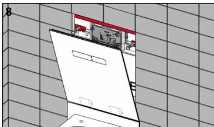
Верхнюю панель смыва вставить в нижние фиксаторы.
