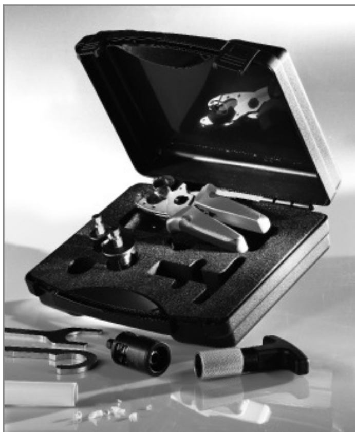
Verktygsväska med röravskärare, kalibrerings- och avfasningsverktyg samt demonteringsverktyg
