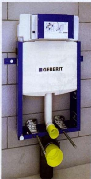
► **Kombifix UP 320** (Geberit). Монтажный элемент для скрытой установки на капитальную стену подвесного унитаза, фронтальное управление. Монтажная высота – 108 см. Глубина – 12 см. Монтаж и ремонт сливного бачка (поставляется в антиконденсационной оболочке) не требуют инструментов. От 4800 руб.
