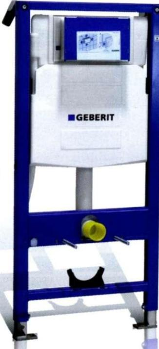
◀ **Duofix UP320 (Geberit, Швейцария).** Универсальный монтажный элемент глубиной 12 см для подвесного унитаза; фронтальное управление; монтажная высота – 112 см. Бачок в противоконденсатной оболочке монтируется без применения инструментов. Фановый отвод снабжён звукоизолирующим креплением. От 8000 руб.
