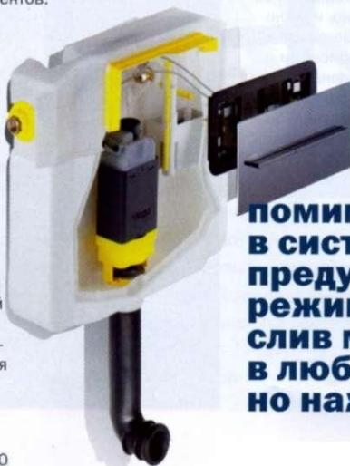
► **Viega Mono** (Viega). Модуль для скрытой установки подвесного унитаза на капитальную стену. Монтажная высота – 98 и 113 см. Простой и удобный монтаж, специальные элементы крепления к кирпичной или блочной стене, фронтальное управление. Поставляется по спецзаказу. От 5200 руб.
