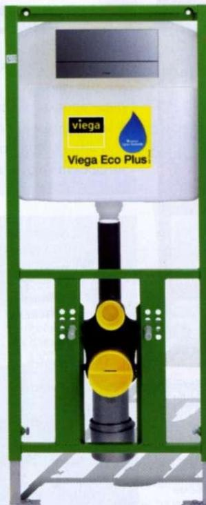
◀ Viega Eco Plus (Viega, Германия). Модуль для скрытой установки подвесного унитаза. Монтажная высота – 113 см. Встроенный механизм самофиксации выдвижных ножек. Высота посадки унитаза регулируется индивидуально. Регулируемое по высоте колено, интегрированный вход для гибкой подводки, отверстия для крепления к деревянным стойкам. От 7800 руб.
