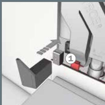
В WC-терминале TECElux, с опцией системы очистки воздуха ceramic-Air, углеродный фильтр (1) рекомендуется заменять примерно раз в пять лет. До него легко можно добраться через верхнюю панель.
