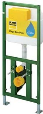
Стальная рама с порошковым напылением «эко» для защиты от коррозии имеет выдвижные опоры с фиксаторами, препятствующими самопроизвольному изменению их положения. Еще один «плюс» — универсальный настенный крепеж для монтажа модуля. Его конструкция разрешает монтаж рамы как на прямую стену, так и в угол.
