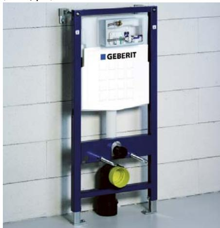
Рама выполнена из массивного прочного стального профиля (толщина стали 2 мм). В конструкции присутствуют металлические усиливающие подкладки, принимающие часть нагрузки консольного унитаза на себя. Рама покрыта антикоррозийным двухслойным лакокрасочным покрытием. Регулируемые опоры снабжены стопорами для предотвращения их резкого выпадения.
