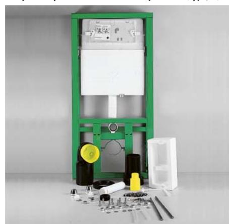
В основе модуля — сварная стальная рама. Система крепится к полу в четырех точках, поэтому рама стоит на четырех «ногах». Благодаря этому вся нагрузка приходится на опоры, а не на стену. При условии правильного монтажа модуль выдерживает до 800 кг веса. Регулировка высоты унитаза осуществляется с помощью выдвижных опор.
