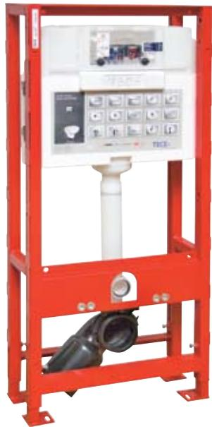
Данный модуль был разработан специально для тех случаев, когда невозможно прикрепить систему инсталляции к стене — например, при некачественных стенах. Двойную раму модели 9.300.031 фиксируют к полу четырьмя выдвижными опорами — и она выдерживает 400 кг.
