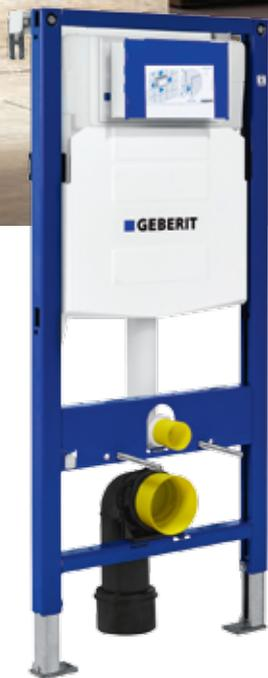
Чтобы не повредить элементы системы в процессе монтажа и чистовой отделки, их снабдили защитными заглушками, предохраняющими патрубок смыва бачка, фановый отвод и окно для установки смывной клавиши и одновременно выступающими в роли шаблонов для маркировки отверстий в отделочном материале. Для защиты санфаянса от повреждения шпильки крепления консольного унитаза закрыты силиконовыми трубками. Шесть возможных положений глубины установки фанового отвода облегчают монтаж системы инсталляции.
