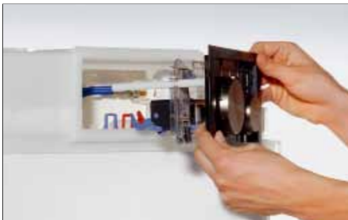
Демонтаж управляющего блока
