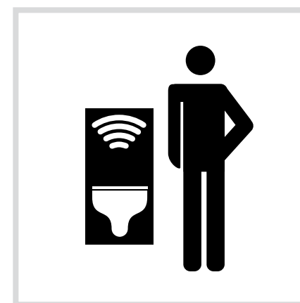
Een sensor achter de glasplaat activeert de verlichting van de display. De afstand waarover personen worden herkend, kan worden verkleind.
