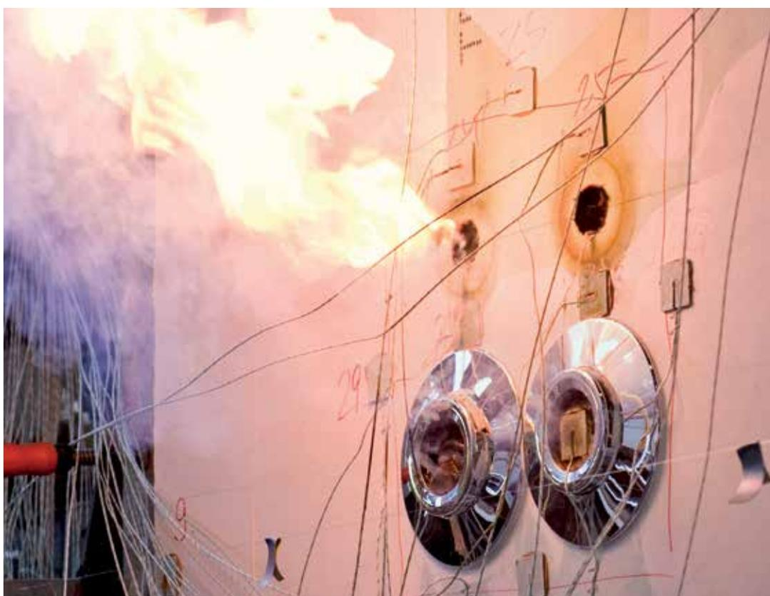
Prova di resistenza al fuoco presso l'Istituto di Prova dei Materiali a Braunschweig (Germania). A seconda del design della struttura a parete, una volta esposta al fuoco su un lato, sono stati raggiunte categorie di resistenza fino a F 120.
