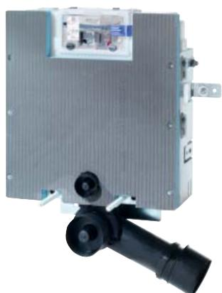
**Cassetta WC TECEbox** altezza di montaggio 820 mm e regolabile in profondità. Azionamento frontale o dall'alto. Pannello di copertura da 3 cm per la posa diretta delle piastrelle.
