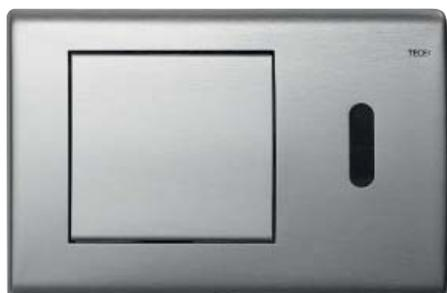
TECE dispone di tre varianti di azionamento elettronico da abbinare alla cassetta: via cavo, wireless o ad infrarossi. In tutte e tre le versioni la placca di comando elettronica lavora con un servomotore alimentato o da una batteria al litio 6 volt, disponibile commercialmente, o da un alimentatore 12 volt. Con il funzionamento a batteria sono possibili circa 25.000 risciacqui.
