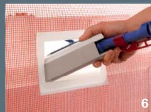
6 Una volta inclinate le leve all'esterno, si estrae la valvola di scarico ruotandola leggermente.
