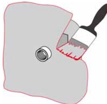
Bild 3: Aufbringen des oberen Dichtanstrichs
