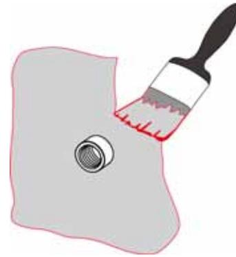
Bild 1: Aufbringen des unteren Dichtanstrichs
