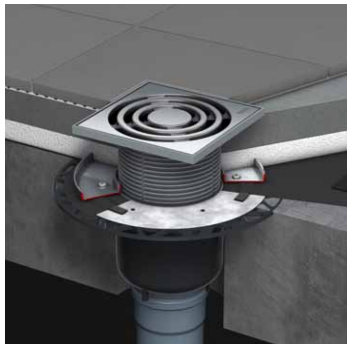
Einbau im Kellerbereich, Abdichtung mit Klemmflanschabdichtung
